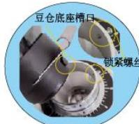
1. 取出豆仓，将豆仓底座槽口对准锁紧螺丝并下压，顺时针旋转豆仓将其卡入，用螺丝刀拧紧螺丝。
