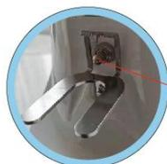
2. 用手柄按动接触开关，开始研磨；放开接触开关，研磨停止。
