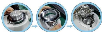
2. 按下顶针片，同时顺时针转动调节杆，拆除调整盘，拆除上刀盘支架。
