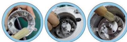
3. 使用清洁刷和布，彻底清洁研磨刀片，螺纹和整个研磨系统。在该装置的螺纹部分建议使用一把小的金属毛刷。
