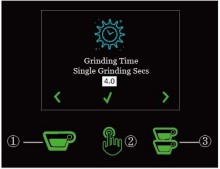
单杯研磨时间设置，可编辑状态下，时间闪烁显示。按①减少0.1秒，按③增加0.1秒，按②确认并进入双杯设置
