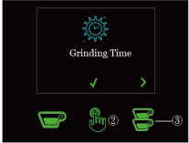
持续按③直到第七个子菜单“研磨方式”，然后按②进入磨粉方式。有4种模式可选：标准模式、自动模式、预选模式和直接模式。
