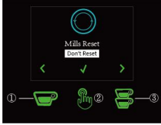
不复位：按①上翻到“铣刀更换”，按③下翻到“铣刀清洗”，按②确认并退出，主页的提醒警告将一直显示。
