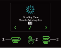
双杯研磨时间设置，可编辑状态下，时间闪烁显示。按①减少0.1秒，按③增加0.1秒，按②确认并返回主菜单
