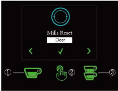
铣刀清洗：按①上翻到“不复位”，按③下翻到“铣刀更换”，按②确认并退出，主页的“铣刀清洗”提示将关闭。
