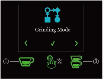
持续按③直到第七个子菜单“研磨方式”，然后按②进入磨粉方式。有4种模式可选：标准模式、自动模式、预选模式和直接模式。
