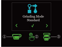
按②确认并返回主菜单，主页面下方显示“标准”按①上翻到直接模式，按③下翻到自动模式。
