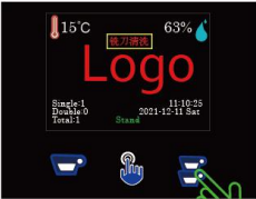
当刀盘使用达到设定的研磨杯数和时间时，主页将会以红色闪烁显示“铣刀清洗”或“铣刀更换”提醒用户清洗研磨系统或更换刀盘。
