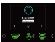
铣刀更换：按①上翻到“铣刀清洗”，按③下翻到“不复位”，按②确认并退出，主页的“铣刀更换”提示将关闭。
