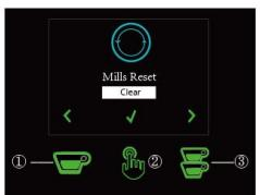
铣刀清洗：按①上翻到“不复位”，按③下翻到“铣刀更换”。按②确认并退出，主页的“铣刀清洗”提示将关闭。
