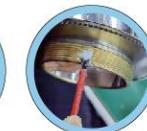
3. 使用清洁刷和布，彻底清洁研磨刀片，螺纹和整个研磨系统。在该装置的螺纹部分建议使用一把小的金属毛刷。
