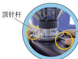
②保持顶针杆按下，同时左右移动调节杆即可调节出粉的粗细度。
