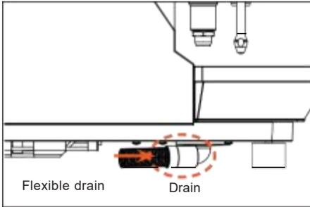
1. 将排水软管的一端连接到位于机器下方的排水出口。（如果您不确定如何进行，请联系维修技术人员执行此任务。）
